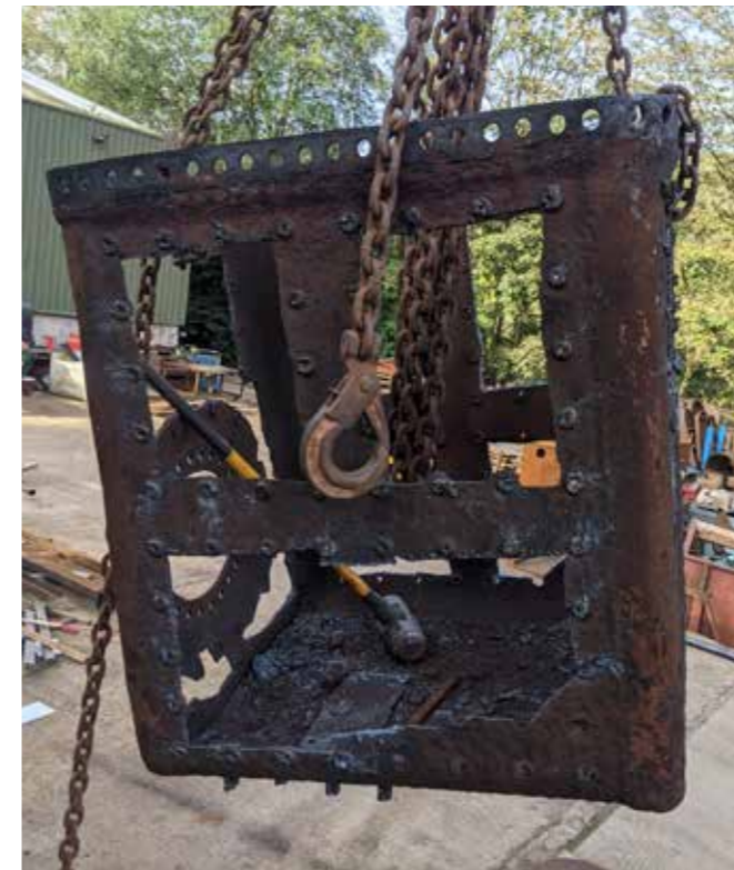
Indre fyrkasse er tatt ut for reparasjon, Setesdalsbanen.
