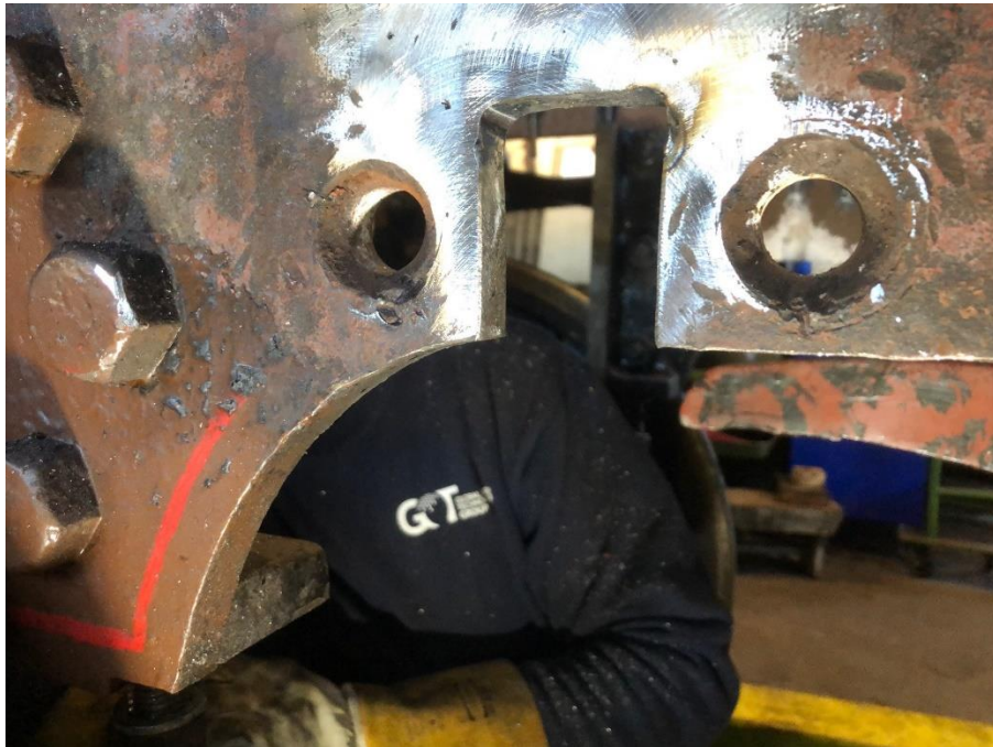
Bilde 7: Ferdig sveis med avrunding på endene
